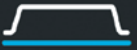
CAP. Конструкция сноуборда, при которой скользящая поверхность, сердечник и ламинат накрываются верхней декоративной поверхностью, как крышкой с боковыми стенками.
